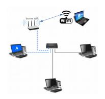
Pour compléter le réseau, on peut rajouter une borne Wifi. Ce boîtier permet de transmettre les informations par ondes radios. L'ordinateur **A** peut donc communiquer avec l'ordinateur **B**. La « portée » et le débit restent limités et plus il y a d'ordinateurs connectés sur la borne Wifi et moins le débit est important.
